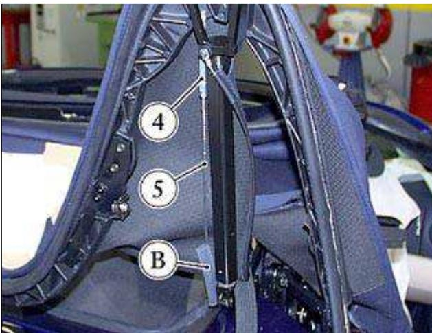
将热缩护套(B)插入绳(5)的末端并拧上后者的锁紧螺母和调节螺钉。拧紧后拱螺纹端上的调节螺钉(4)，保持初始长度。
