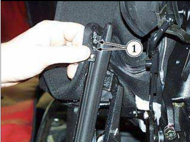
● 要接近拉杆对中销, 有必要从侧面立柱分离帆布, 松开使用密封圈紧固接头臂的螺钉(1)。
